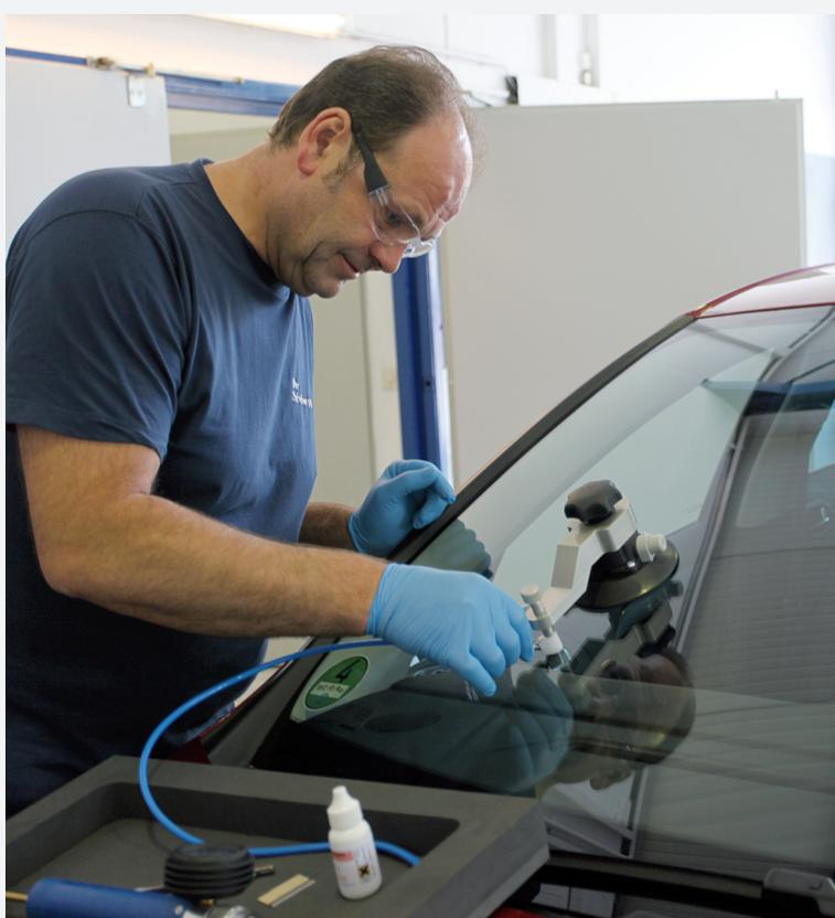
Inhaber Rolf Gotter bei der Reparatur eines Steinschlagschadens.
